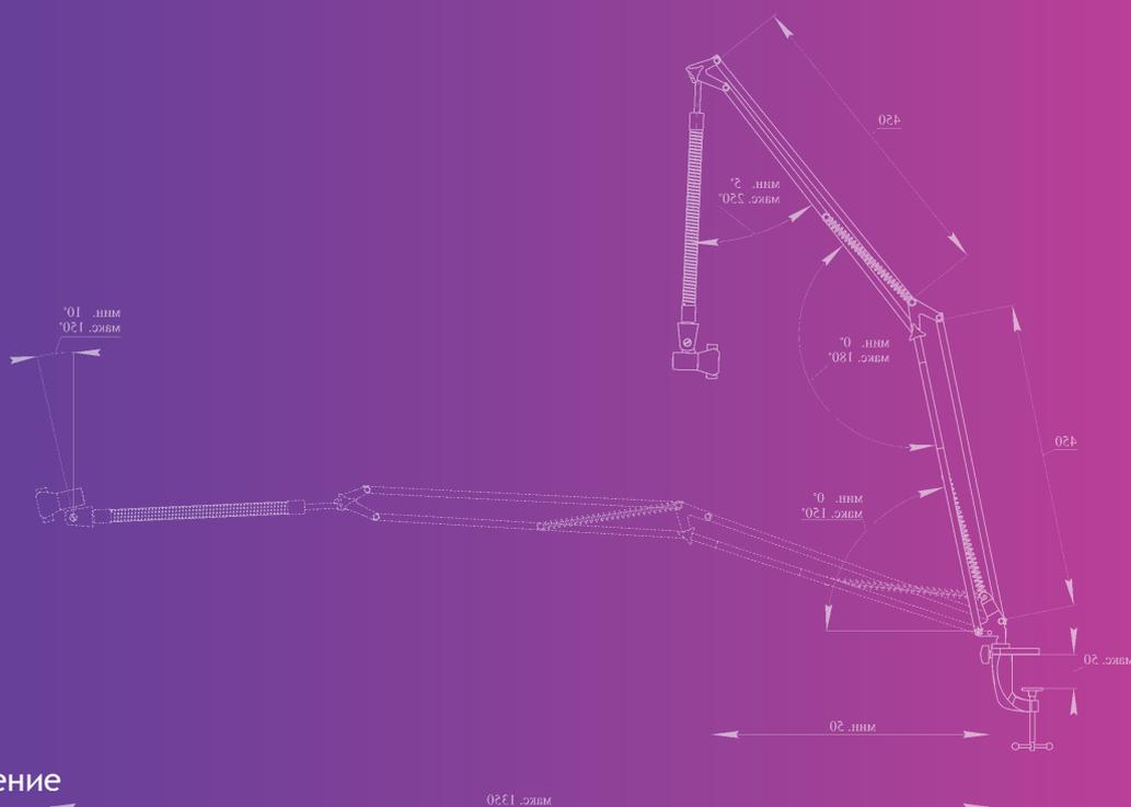
Штатив служит для крепления оптических насадок, световодов лазерной медицинской аппаратуры и осветительных систем для фиксации их в рабочем положении и освобождении медицинского персонала в собственноручном их удержании. За счёт вращения по окружности диаметром достигающей 2,7 м возможно установить излучающее изделие в любой точке роста пациента.
